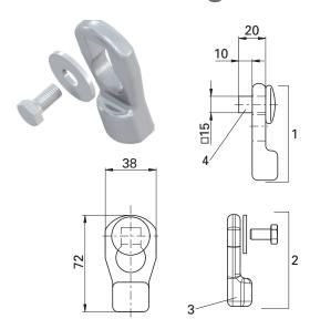
Verwendung: Sichern der Spannmutter bei Verriegelungen und Querträgern gegen unbeabsichtigtes Lösen. Passend für alle Verriegelungen außer F 10 SK, R 411 VAK, R 316 VAP und R 305 VAP.
