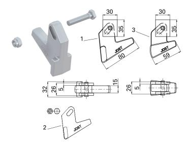
Verwendung: Sichern der Spannmutter bei Verriegelungen und Querträgern gegen unbeabsichtigtes Lösen.
