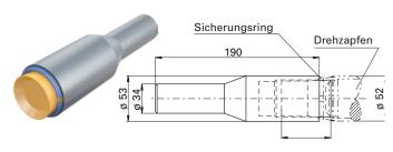
MW 52 für Drehzapfen ø 52
